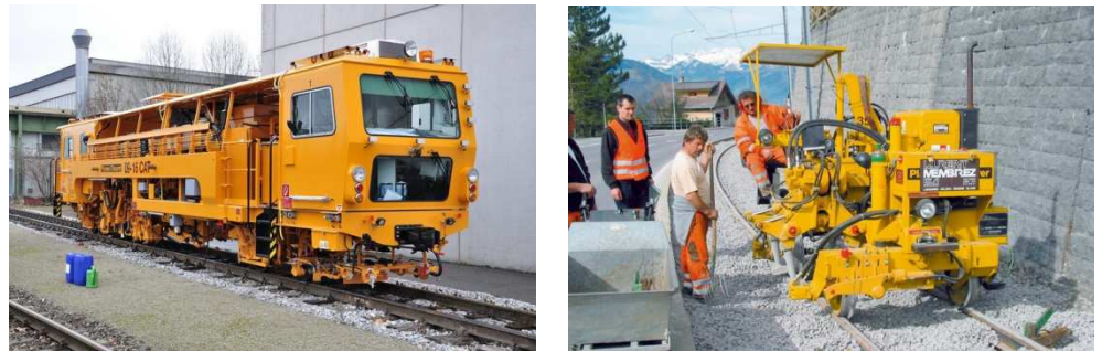
Figur 4 Almindelig og mini komprimeringsmaskine. Fotos ©Plasser Theurer.
